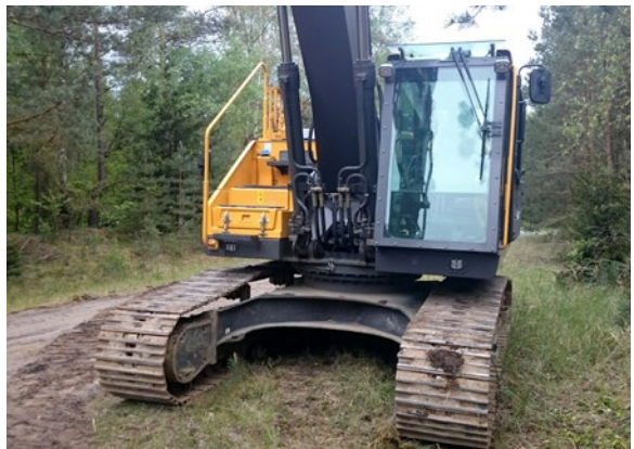
Abb. 12 Bagger mit Sicherheits- sonderverglasung
